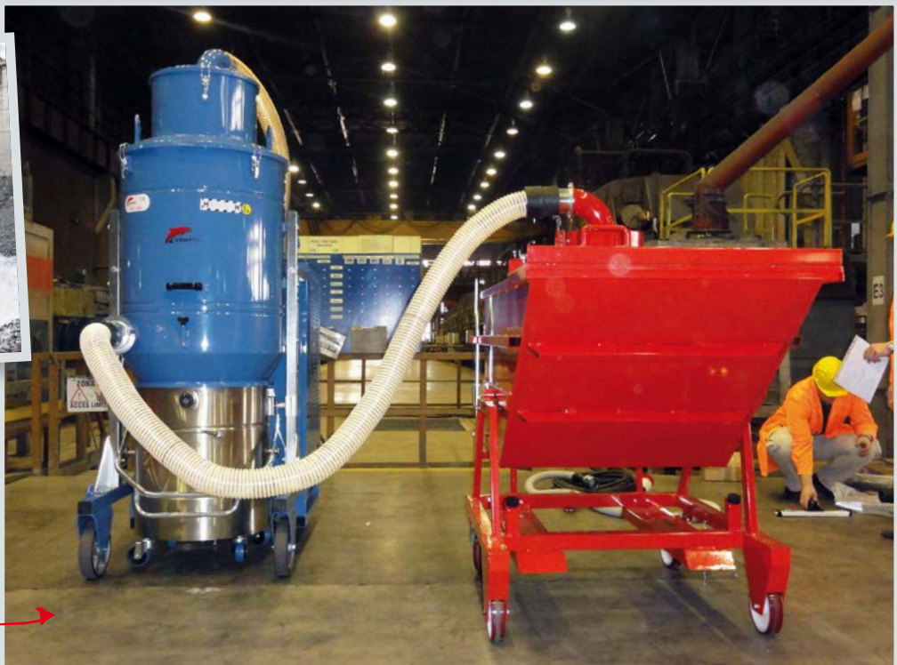
Pre-Separatori mobili, ribaltabili di grande capacità Tilting pre-separators, high capacity (400 - 600 Lt)
