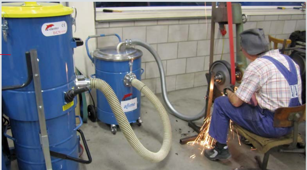
Pre-Separatori per sostanze incandescenti Pre-separators for hot materials
