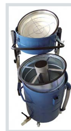
Contenitore a sgancio per svuotamento rapido Detachable container for fast discharge
